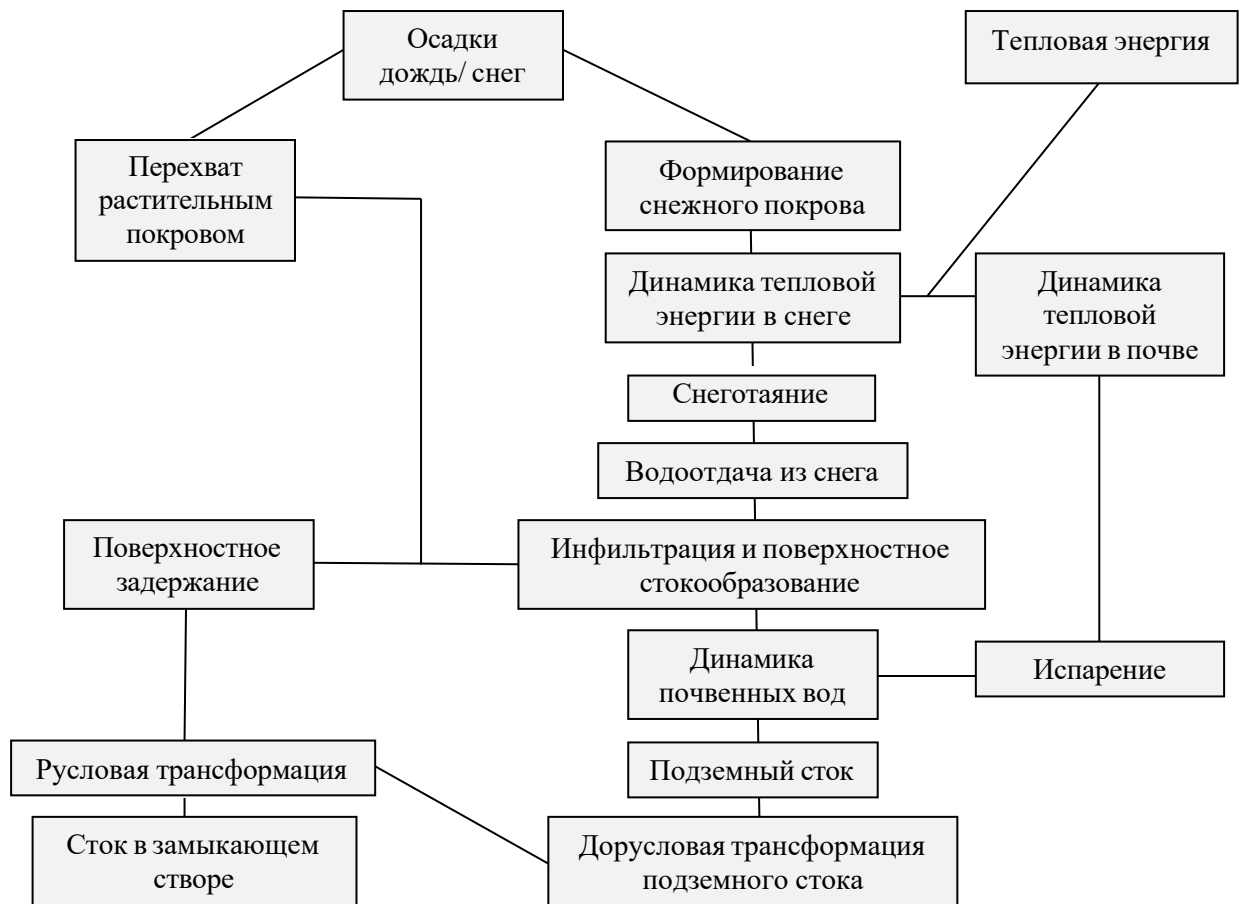
Рис. 1.1. Система процессов формирования стока (по Ю.Б. Виноградову, 1988)
