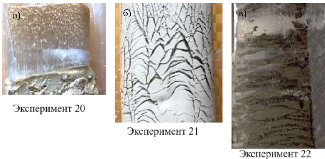
Рис. 1.6. Примеры криотекстур экспериментальных образцов: а) – толстая линза чистого льда в каолине при небольшом градиенте температуры и остановке фронта сразу за ней; б) шлировая параллельно-выпуклая слоистая криотекстура в каолине при принудительном продвижении фронта за счет пошагового снижения температуры; выраженная слоистая криотекстура в игарском суглинке
