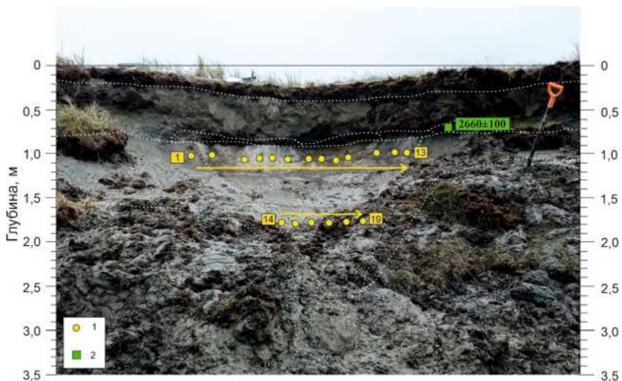
Рис. 4.10. Залегание ПЖЛ на лайде - полевая точка 24YR-1 (а) и на первой террасе – полевая точка 24YR-2 (б): 1 – места отбора образцов на изотопный анализ, 2 – места отбора образцов торфа на радиоуглеродный анализ. Фото Л.П.Кузякина.
