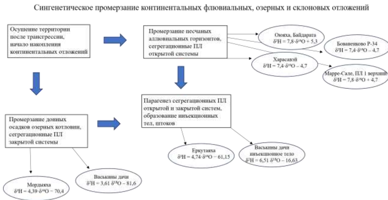
Рис. 5.2. Основные механизмы и соответствующие им диагностические уравнения \delta^2\text{H} - \delta^{18}\text{O} для пластовых льдов Западной Сибири
