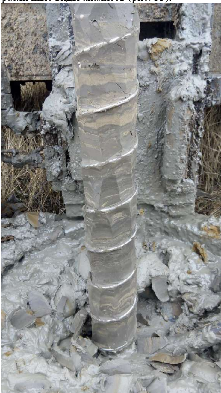
Рис. 35. Пример добытого керна в слабо нарушенном состоянии методом вращательного бурения (шоколадные глины в скв. 211071 на глубине 17,5 м)
