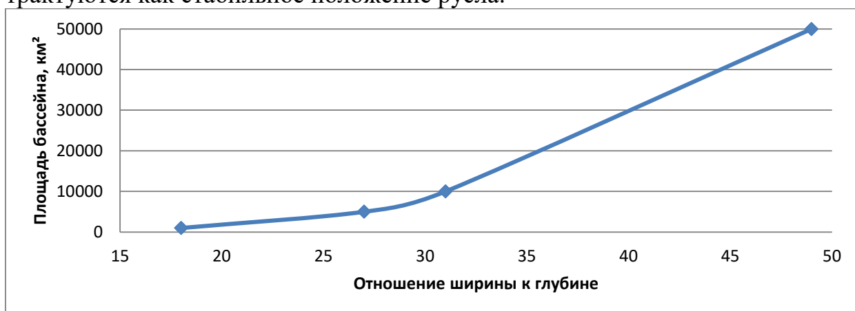
Рисунок 121. Соотношение ширины реки в межень и максимальной глубины к площади бассейна (по Нежиховский, 1971)
