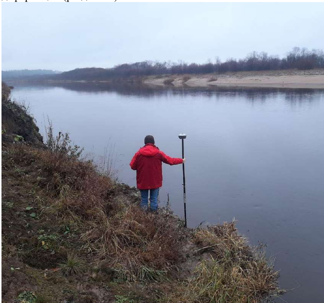
Рис. 36. Процесс измерения абсолютной высоты GNSS-приёмником (р. Унжа)
