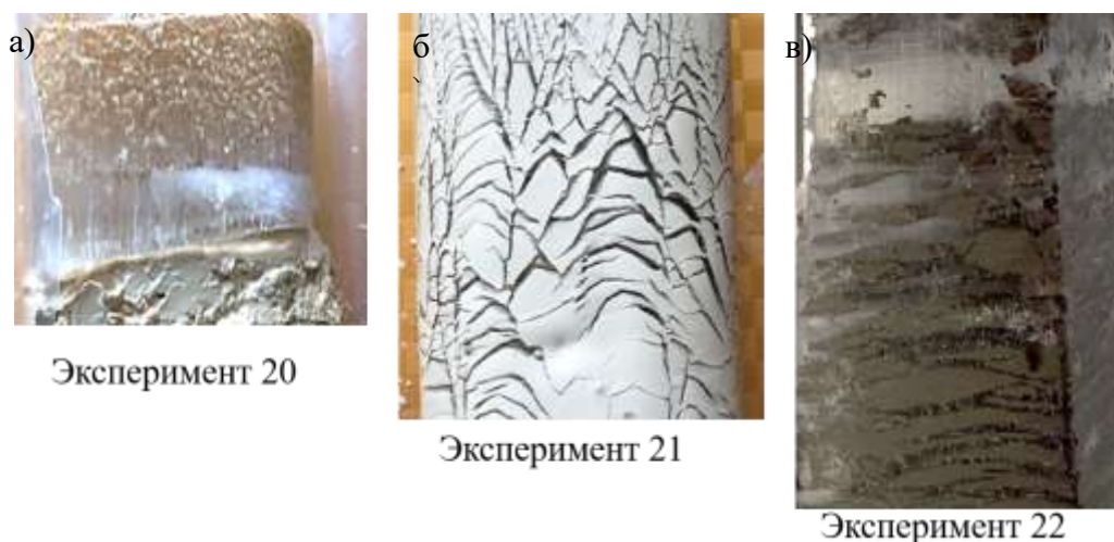
Рис. 3. Примеры криотекстур экспериментальных образцов: а) толстая линза чистого льда в каолине при небольшом градиенте температуры и остановке фронта сразу за ней; б) шлировая параллельно-выпуклая криотекстура в каолине при принудительном продвижении фронта за счет пошагового снижения температуры; в) выраженная слоистая криотекстура в игарском суглинке
