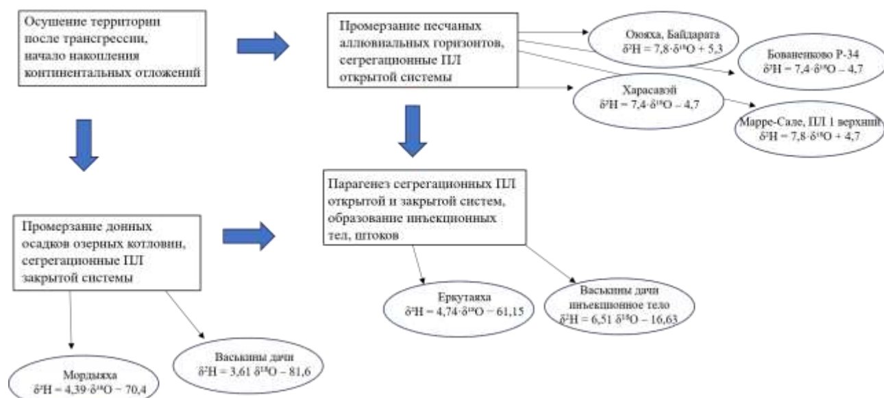
Рис. 15. Основные механизмы и соответствующие им диагностические уравнения \delta^2\text{H}-\delta^{18}\text{O} для пластовых льдов Западной Сибири
