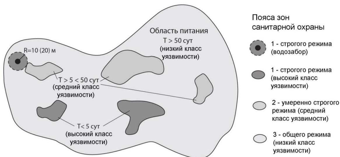
Рис. 7. Предлагаемая концептуальная схема установления границ зон санитарной охраны для водозаборов карстовых вод в Горном Крыму на основе карты полной уязвимости подземных вод.
