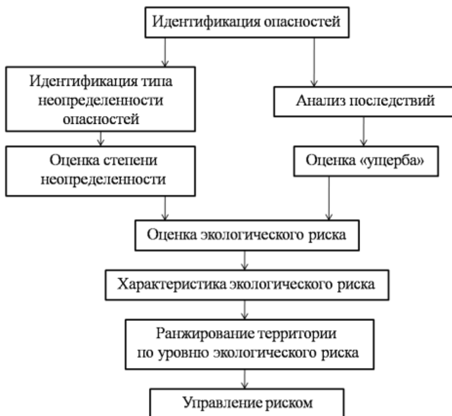
Рисунок 3.1 - Блок-схема последовательности оценки экологического риска
