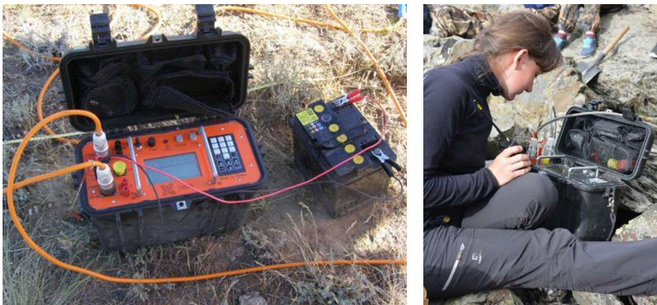
Рисунок 2.4. – Многоэлектродная электроразведочная станция «СКАЛА-48» (фото Останина О.В.)
