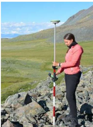
а) GNSS-съемка по линии профиля электротомографии криогенного потока (фото автора)
