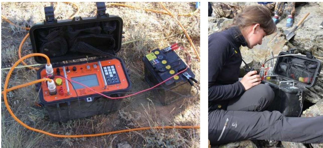
Рисунок 2.4. – Многоэлектродная электроразведочная станция «СКАЛА-48»
