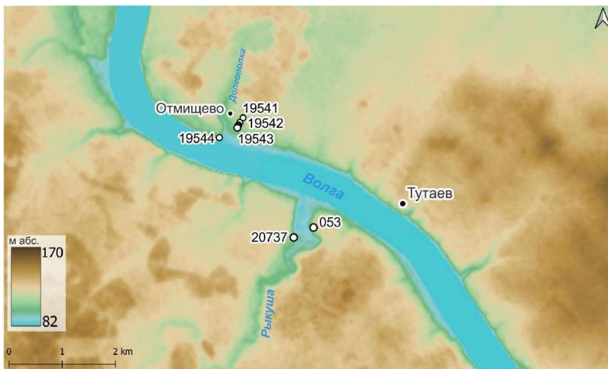
Рис. 3.14. Положение упоминаемых в тексте разрезов и скважин в окрестностях г. Тутаева. На террасовидной поверхности на правом борту долины Рыкуши (рис. 3.14) нами была заложена расчистка 053 (абс. высота поверхности 124 м, высота уреза Рыкуши – 87 м), вскрывшая отложения видимой мощностью 4,6 м (рис. 3.15).
