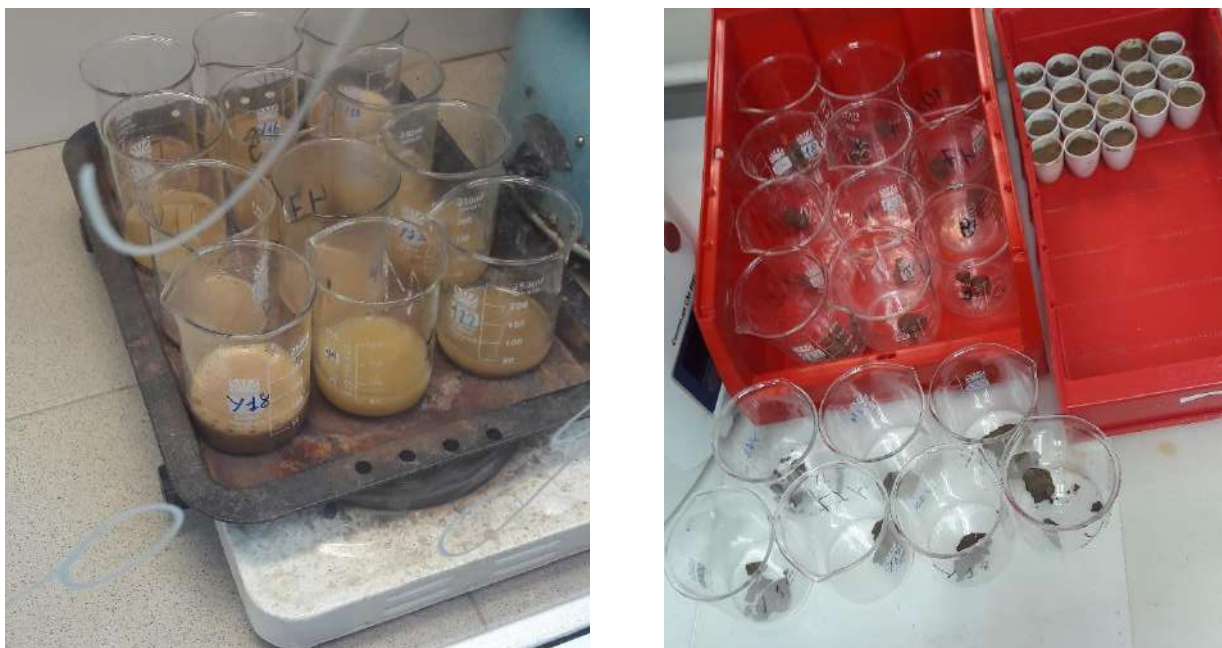
Рис 2.1. Пробоподготовка образцов для гранулометрического анализа (слева – обработка концентрированной перекисью водорода, справа – подготовленные навески образцов для лазерного анализатора и ППП) (фото автора).
