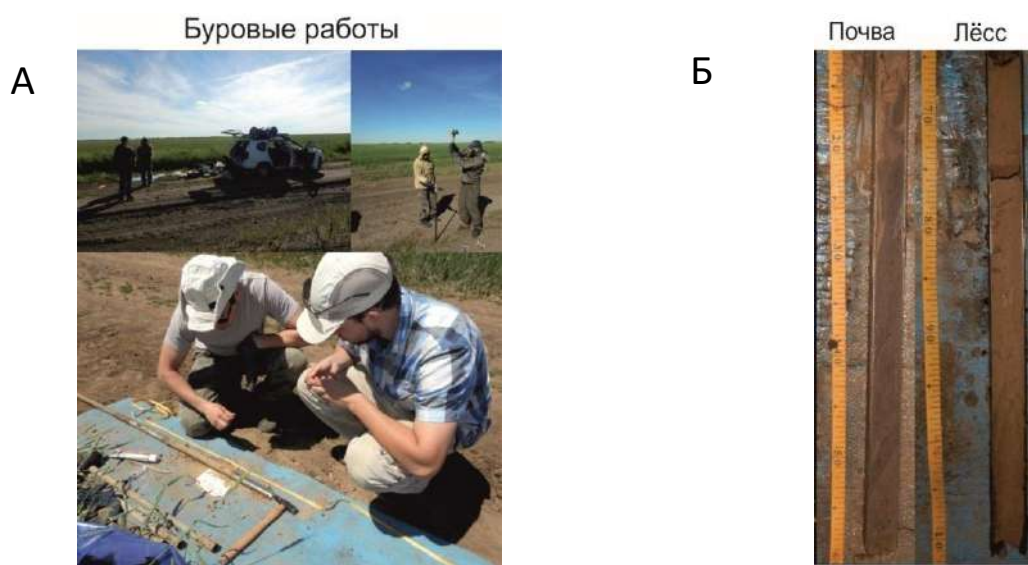
А – процесс буровых работ; Б – пример 30 см кернов в полуцилиндрическом пробоотборнике
