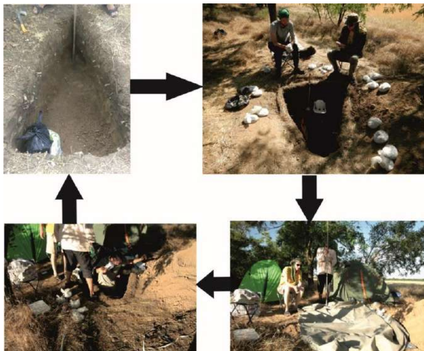
Рисунок 56. Отбор люминесцентных образцов из шурфа, накрытого светонепроницаемым материалом (Фото А.Л. Захарова)
