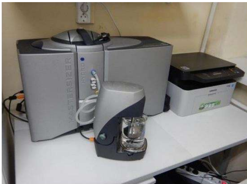
Рисунок 59. Лазерный анализатор размеров частиц Malvern Mastersizer 3000 в Лаборатории палеоархивов природной среды ИГ РАН
