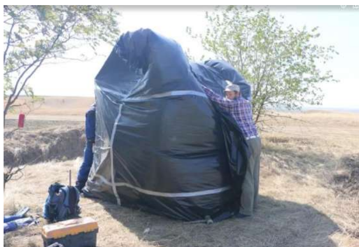
Рисунок 57. Отбор люминесцентных образцов с использованием палатки, накрытой непрозрачным тентом
