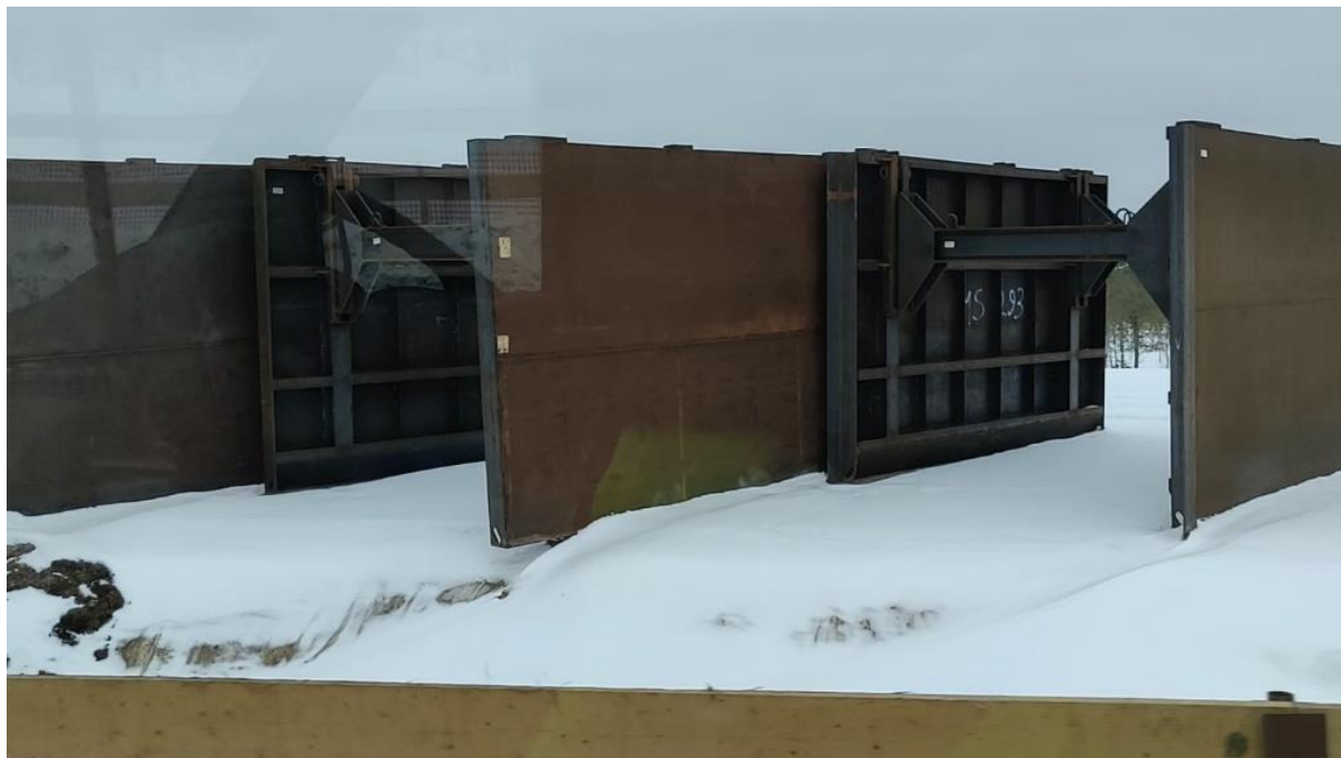
Рисунок 5.7 – Траншейные крепи (тренч-блоки)
