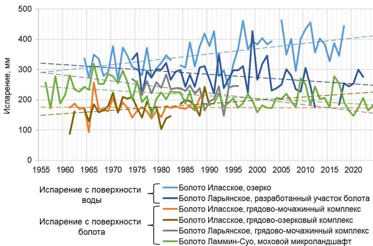
Рисунок 2.9 – Суммарное измеренное испарение за летний период (июнь-август) с водной поверхности и поверхности болота
