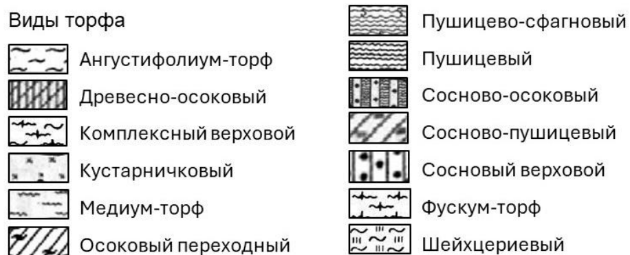
Рисунок В.8 –Условные обозначения видов торфа, представленных на схемах
