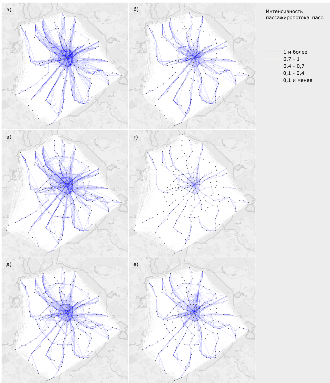
Рисунок 31. Пространственное распределение среднесуточной пассажиронапряженности пассажиропотока между всеми парами станций и узлов Московского метрополитена: а) в будние дни IV квартала 2019 г.; б) в выходные дни IV квартала 2019 г.; в) в будние дни IV квартала 2023 г.; г) в выходные дни IV квартала 2023 г.; д) в будние дни лета 2023 г.; е) в выходные дни лета 2023 г. Составлено автором.
