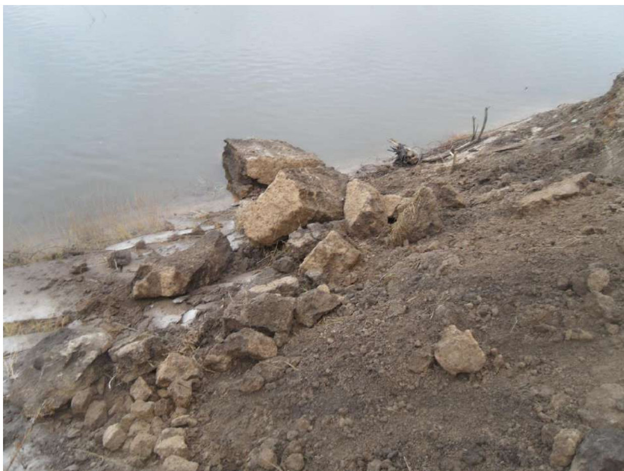
Рис. 57. Пример боковой эрозии на Кальновской излучине, обрушение берега по уязвимым песчаными прослоям.
