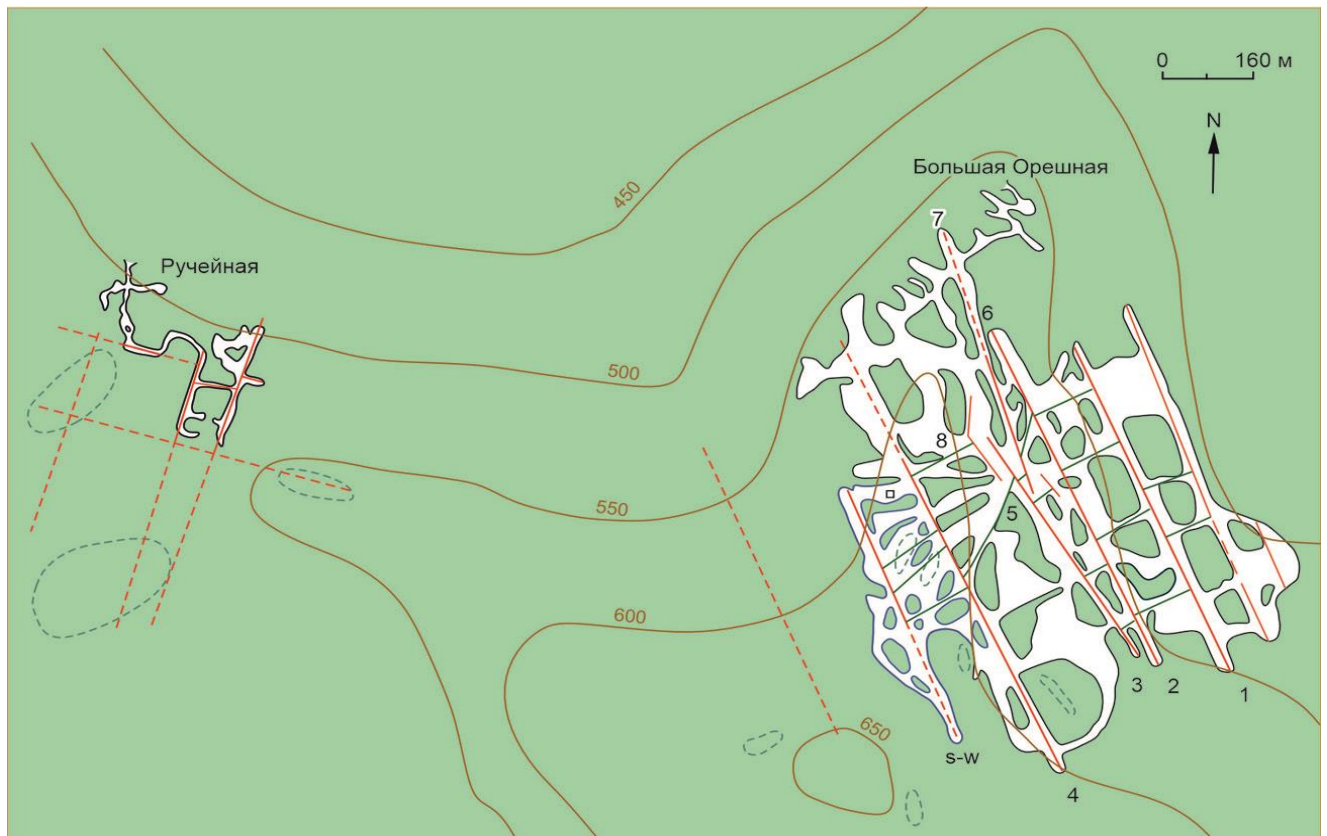
Рисунок 3. Выявленные разрывные нарушения и привязка карты пещер Большой Орешной и Ручейной к дневной поверхности.
