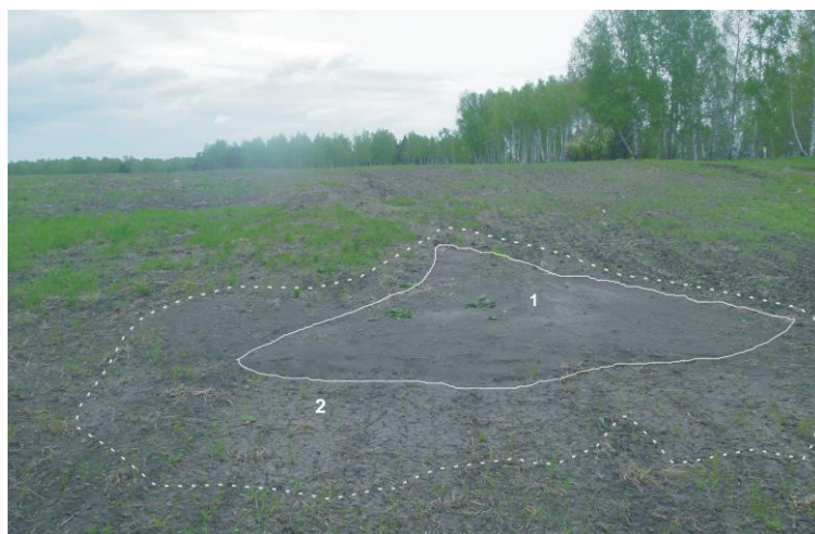
Рис. 3. Конус правильной геометрической формы (1), окруженный слоем аккумулярованных наносов меньшей гидравлической крупности (2) в пределах участка № 5 (май 2009 года).
