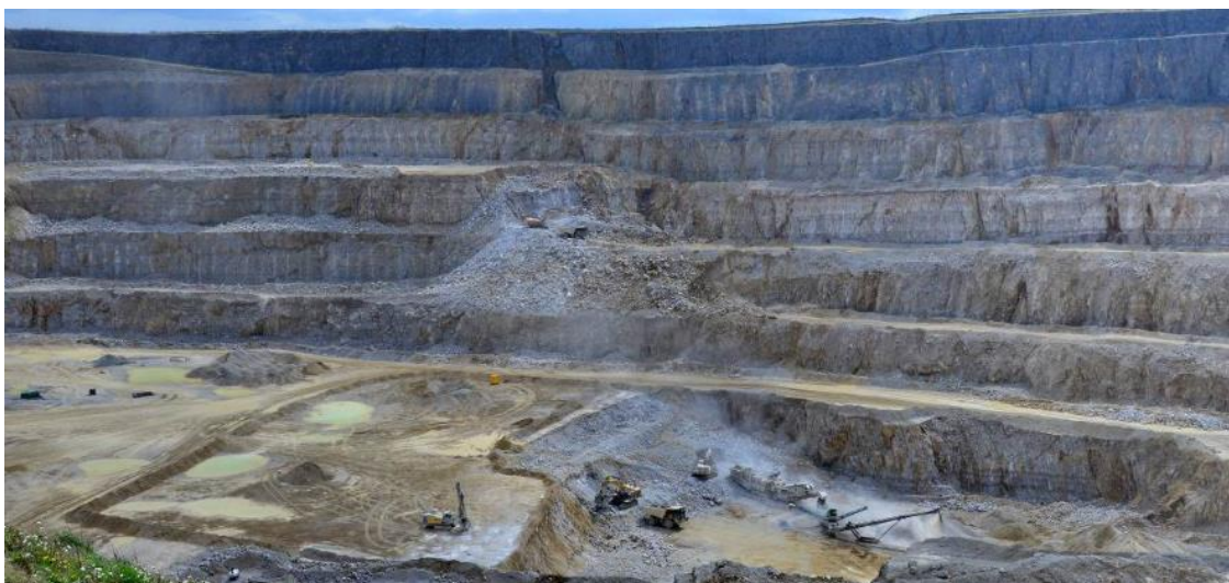
Известняковый карьер Даулоу (Dowlow) в Пик Дистрикт, Великобритания. Площадь карьера около 0.5 km 2 , и в 2021 г. его самая низкая точка располагалась примерно на 100 м ниже поверхности земли, но карьер не пересекал никакие каналы или пещеры, не было никакого притока грунтовых вод со стен карьера. Фото: Tony Marsden.
