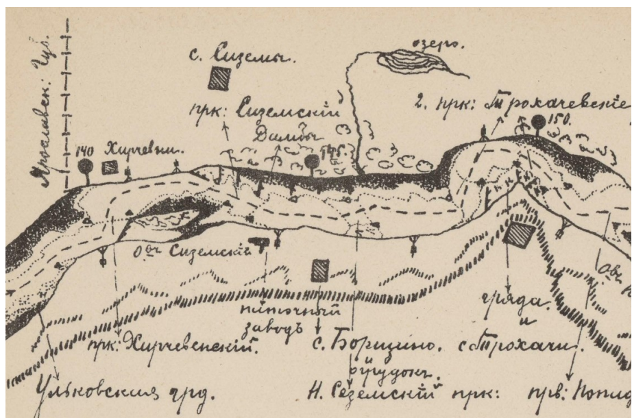
Рис. 5. Фрагмент карты лоции р. Волги с обозначенными дамбами и перегороженными волужками в районе Сиземского переката (из «Атлас практических карт реки Волги...» [Атлас практических карт..., 1910]).
