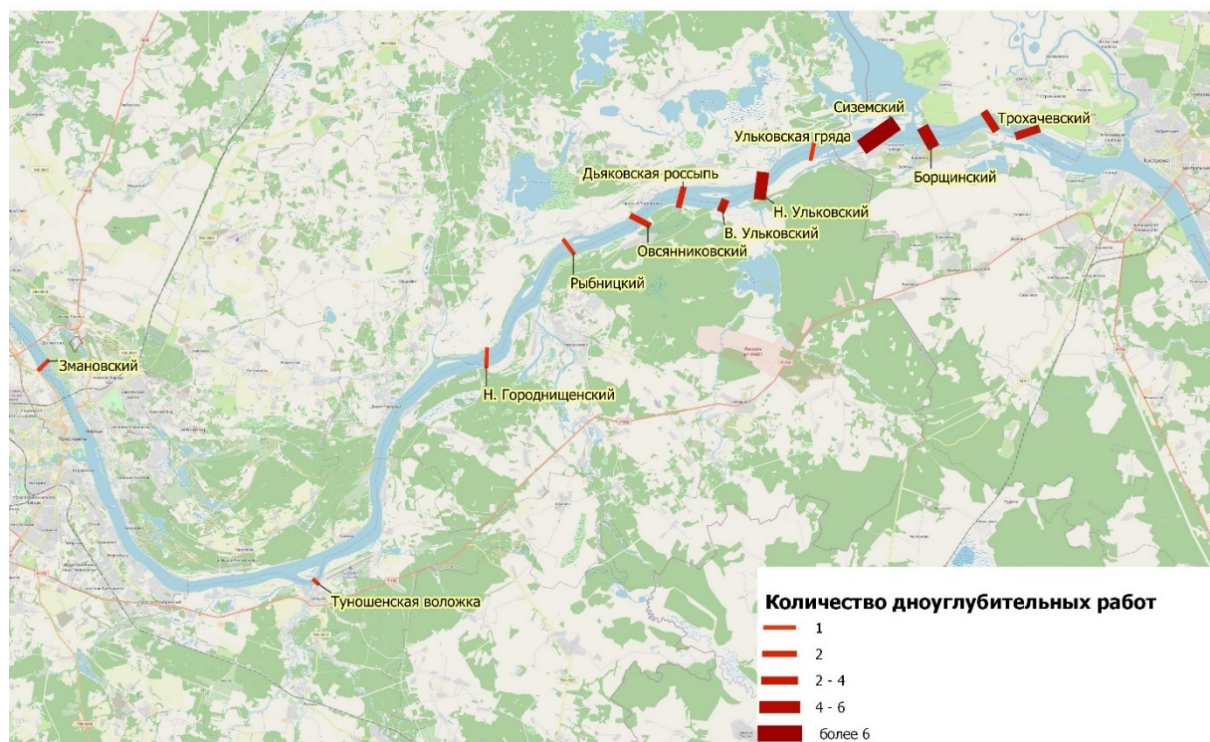
Рис. 6. Перекаты, на которых проводились дноуглубительные работы в период с 1901 по 1908 гг. (по данным «Землечерпательные работы Министерства путей сообщения...», 1908, 1910).
