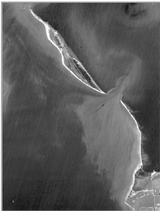
Рис. 2. Формирование особых гидрологических условий после завершения строительства основной части дамбы от Таманского полуострова до острова-косы Тузла (космический снимок, октябрь 2004 г.)
